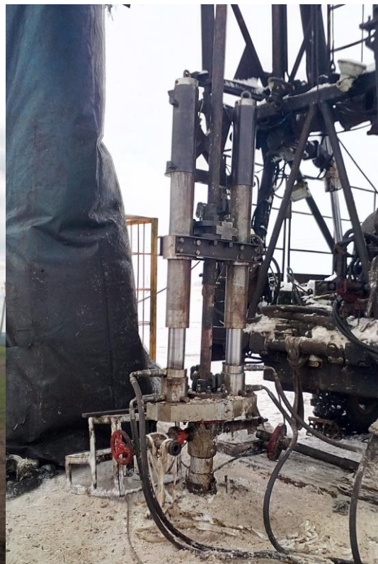
Рис. 4. Работа домкрата на скважине с опорой на муфту и план-шайбу
