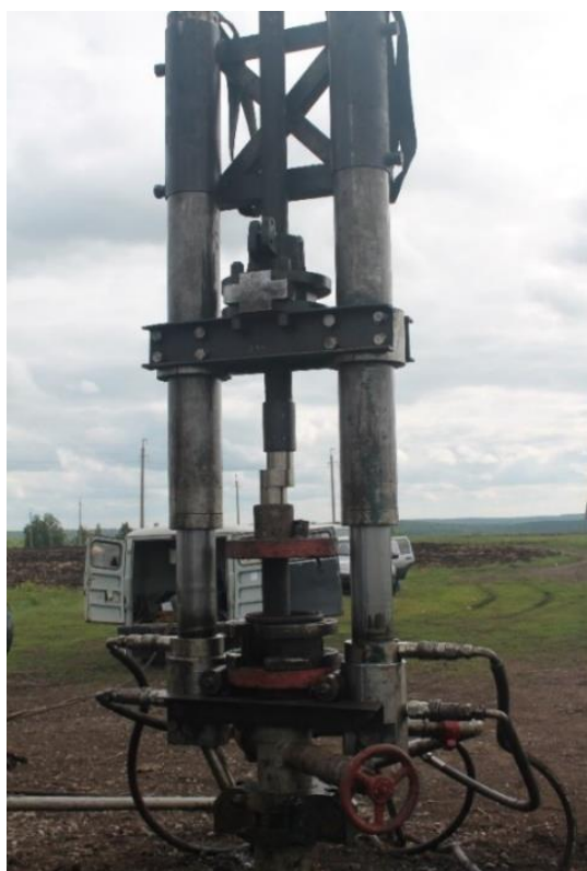
Рис. 4. Работа домкрата на скважине с опорой на муфту и план-шайбу
