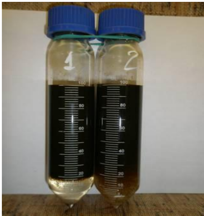
Рис. 1. Влияние депрессора Flexoil WM 1740 на отделение воды смеси нефти Колвинского, Инзырейского и Средне Харьягинского месторождений
