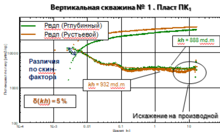
Рис. 4. Диагностический график в вертикальной скважине
