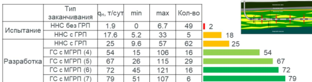
*Рис. 8. Эволюция запускных дебитов нефти Ем-Еговского ЛУ в результате совершенствования технологии заканчивания скважин*
