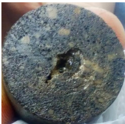
Входной торец образца 6052-3 после кислотной обработки
