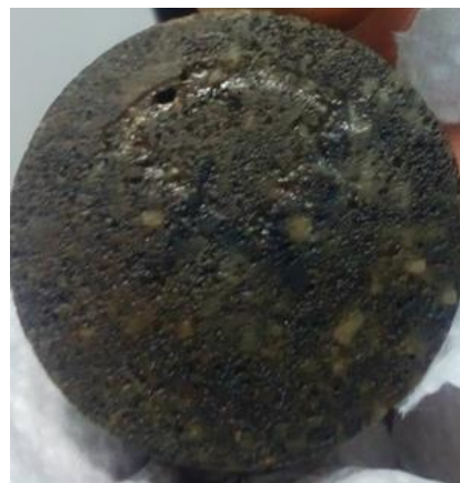
Выходной торец образца 6052-3 после кислотной обработки
