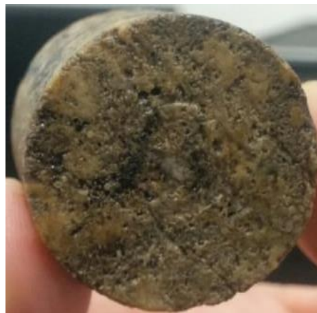
Выходной торец образца после кислотной обработки
