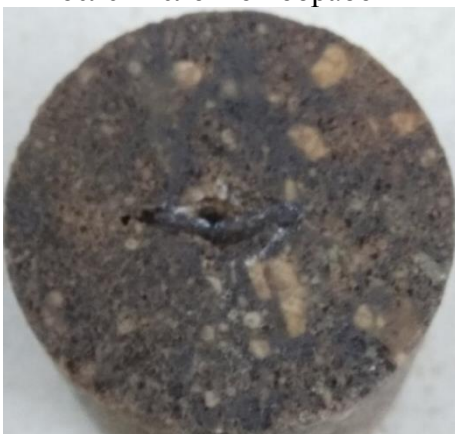
Входной торец образца 6052-2 после кислотной обработки
