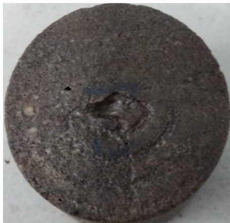
Входной торец образца 6052-1 после кислотной обработки
