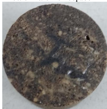
Выходной торец образца 6052-2 после кислотной обработки
