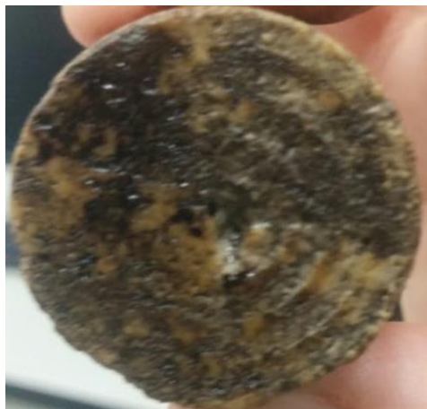
Входной торец образца после кислотной обработки
