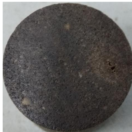
Выходной торец образца 6052-1 после кислотной обработки
