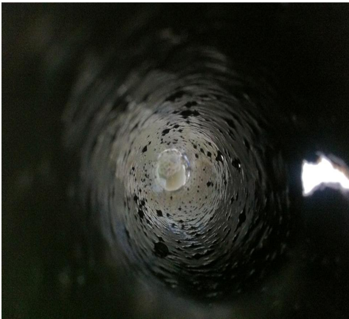
Рис. 8. Прорыв газа через тампонажный раствор из портландцемента
