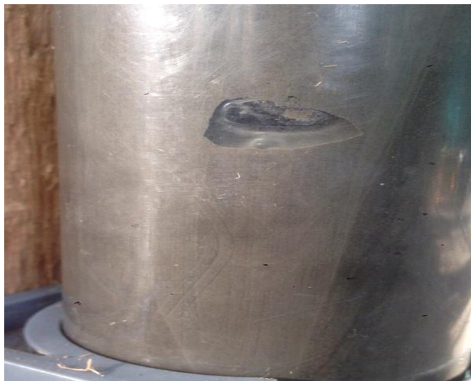
Рис. 10. Образование пустот и скапливание газа в тампонажном растворе с газоблокатором CFL-117
