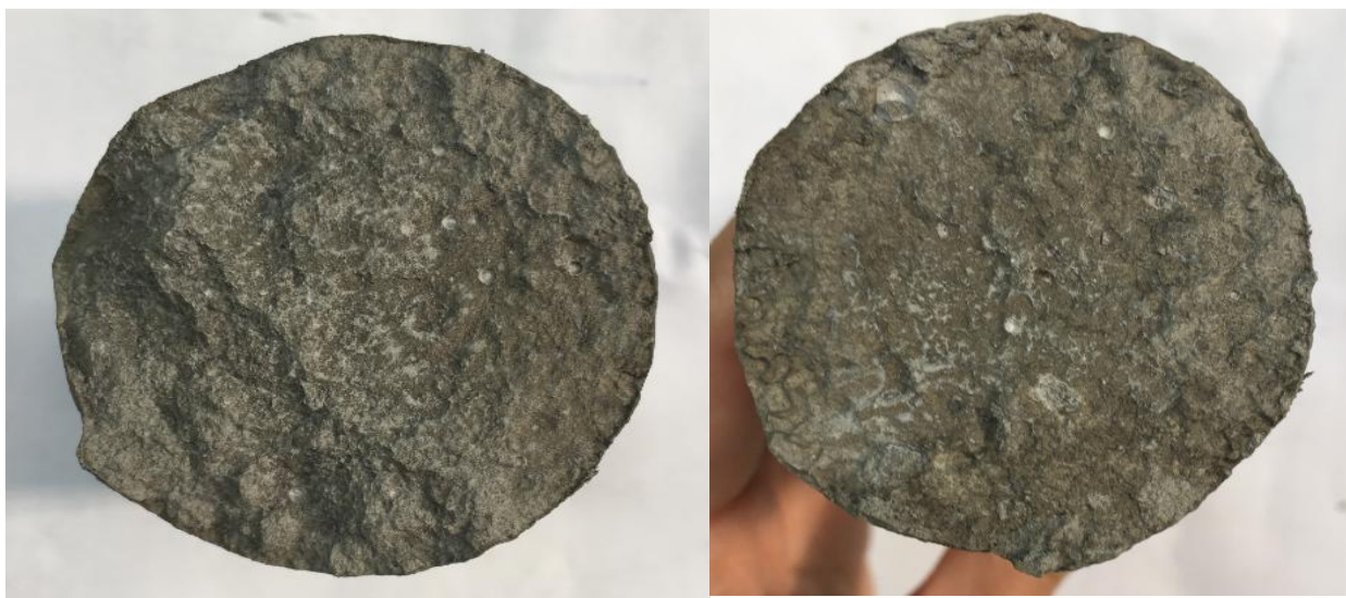
Рис. 11. Образцы цементного камня с ВПК-402 7%
