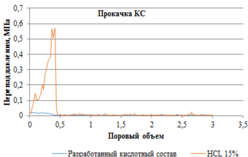
Рис. 4. Перепад давления по сравниваемым составам, прокачанным на фильтрационной установке, через образец керна скважины 2801г
