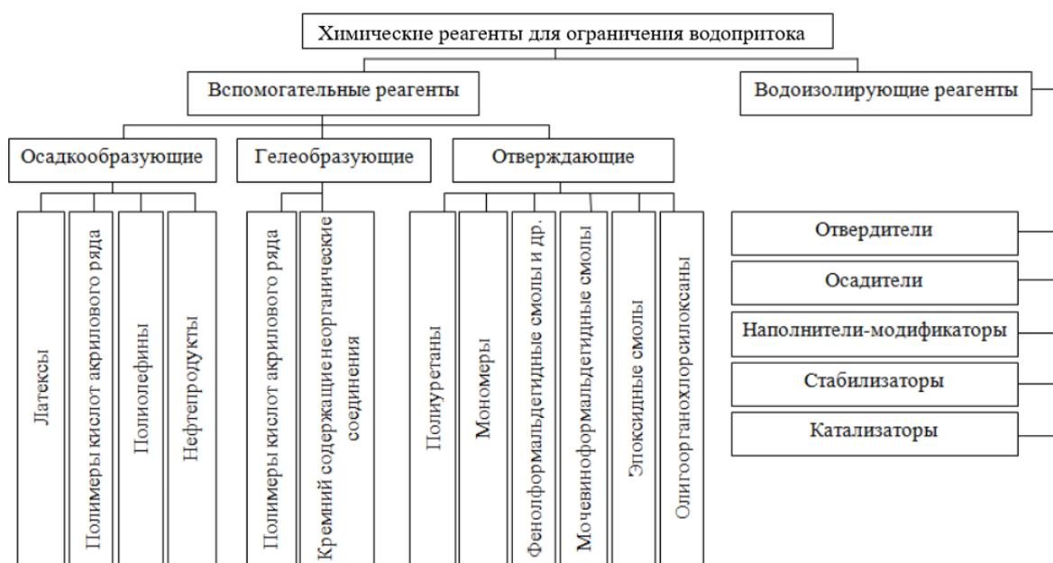
**Рис. 1. Схема классификации химических реагентов для ограничения водопритока**
