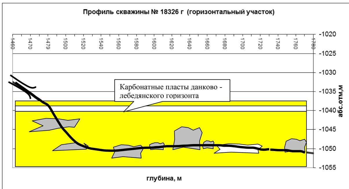
Рис. 11. Схема ствола горизонтальной скважины № 18326 в продуктивном пласте.
