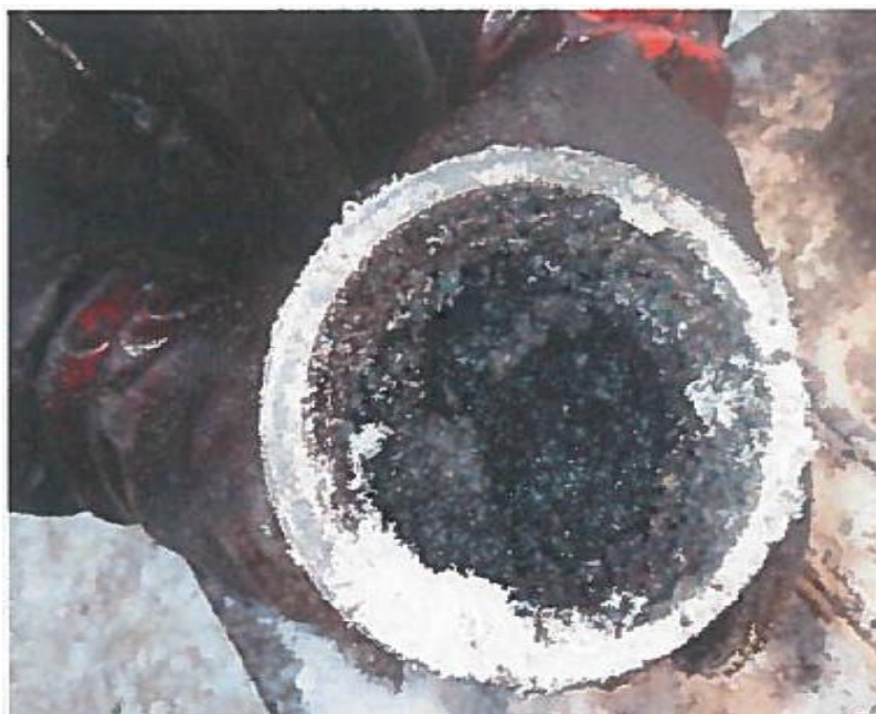
Рисунок 3. Фото засора обратного клапана скважины №229 пропантом
