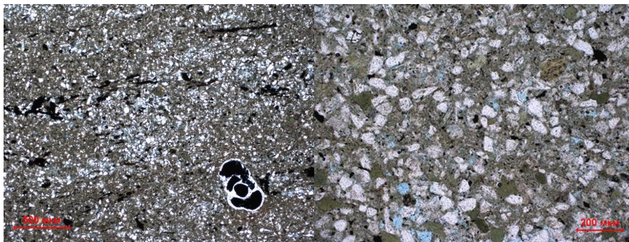
Рис. 5. Фото илифов. Пачка ВБ1. (А) Глубина по бурению 863,90 м. Алевролит мелкозернистый, с поровым глинистым цементом, с примесью глауконита, ОВ, пиритизированный, биотурбированный, неравномерно микропористый, с остатками фораминифер; без анализатора \times 50 . (Б) Глубина по бурению 859,20 м. Алевролит мелко-крупнозернистый, с поровым глинистым цементом, с глауконитом, с примесью ОВ, пиритизированный, биотурбированный, неравномерно пористый; без анализатора \times 100 . (ООО «ТННЦ», 2018)
