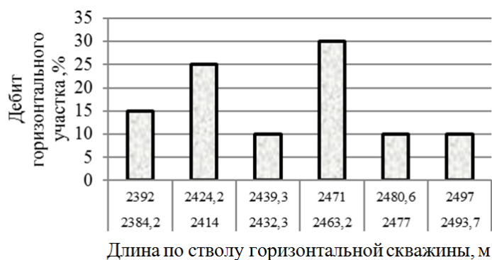
Рис. 4. Профиль притока для ГС, реальный пример
