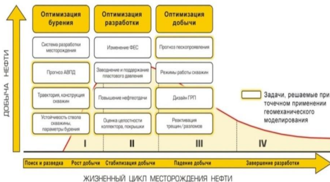
Рис. 1. Комплекс задач, решаемых с помощью геомеханического моделирования.
