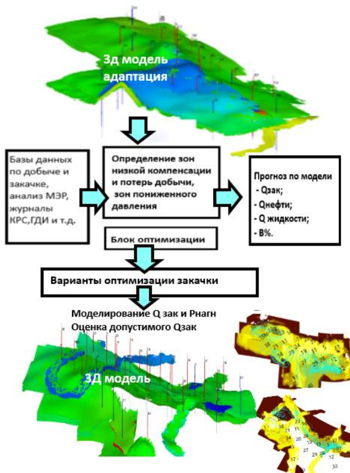
Рис. 4. Схема алгоритма оптимизации системы разработки залежей нефти в русловых отложениях
