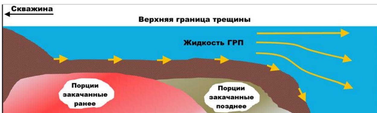
*Рис. 2. Последовательность распределения жидкости и проппанта в трещине*
