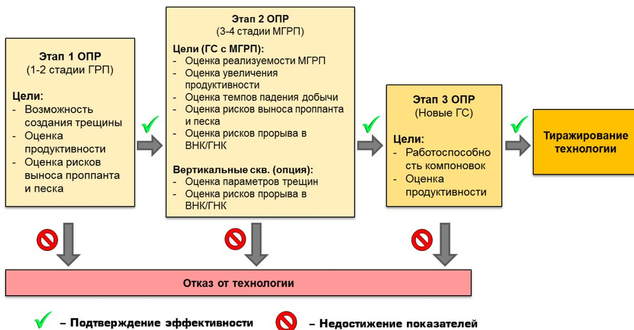
*Рис. 4. Общая схема опытно-промышленных работ с ГРП на Русском месторождении*
