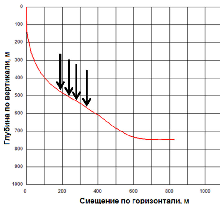
Рис. 1. Вертикальная проекция профиля скважины
